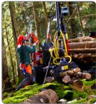
Hydraulische Winde mit Funkfernsteuerung.
