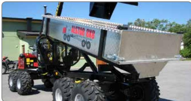
Hydraulischer Kippaufbau aus Stahl oder Aluminium.
