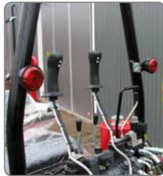
Mechanische 2-Hebel-Bedienung mit elektrischem EIN/AUS-Schalter.
