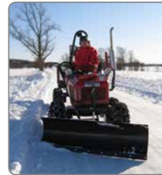
Schwenkbarer 180-cm-Schneepflug, Hydraulikhub.
