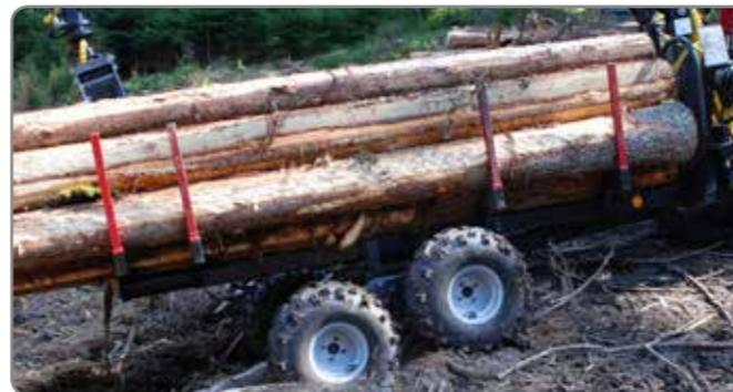
Teleskopträger und abnehmbarer Träger mit Streben.
