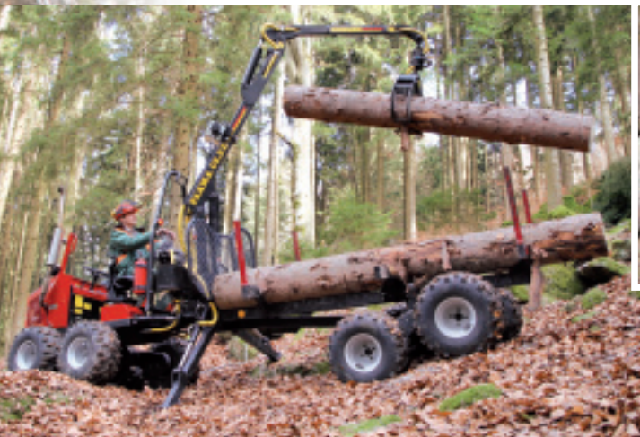
▲ Zwischen den Rungen des Forstaufbaus können bis zu vier Raummeter Stammholz transportiert werden.
