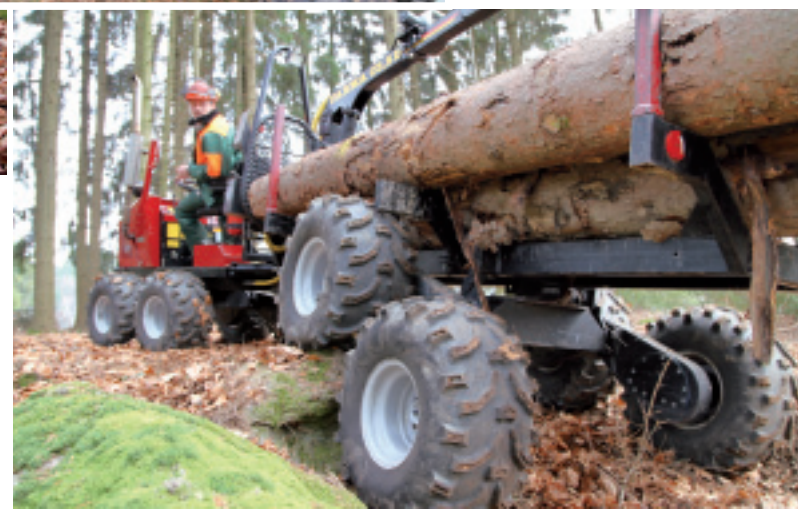
▲ Zwischen den Rungen des Forstaufbaus können bis zu vier Raummeter Stammholz transportiert werden.
